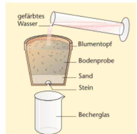
7 Versuchsaufbau Boden als Filter
